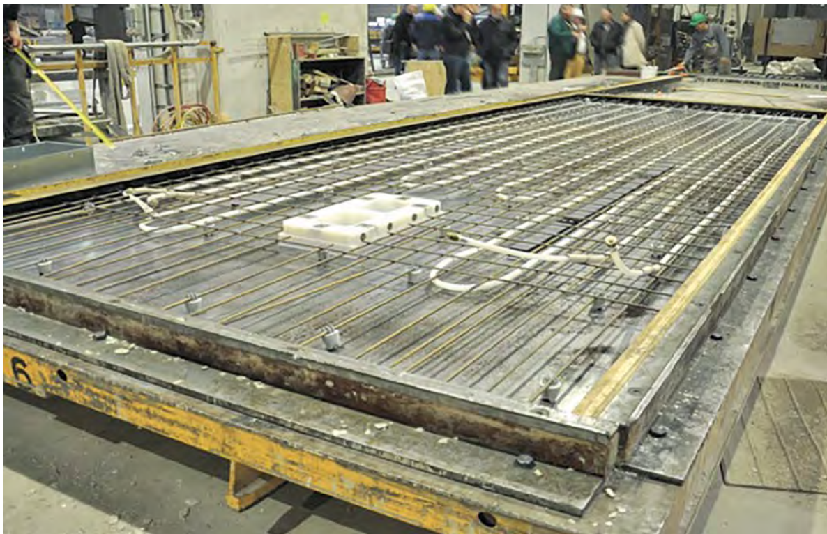
Einbau der vorgefertigten Bewehrungseinheit mitsamt der Rohrregister in den Schaltisch.
