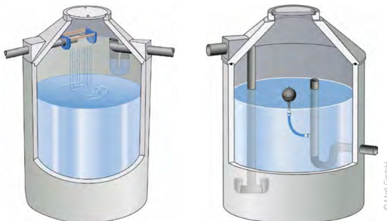
Schematische Darstellung von Regenwasserzisternen.
