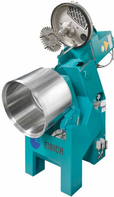
Konsistenzmessung im Betonmischer integriert.
