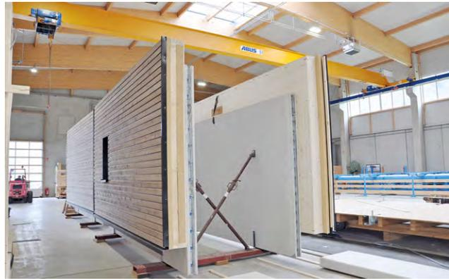
Werkseitige Herstellung der Hybridwand in Holz-Beton-Verbund.
